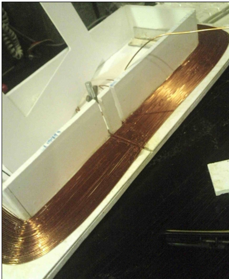
Figure 124 - Vue détaillée de l'enroulement autour des parties en PVC
