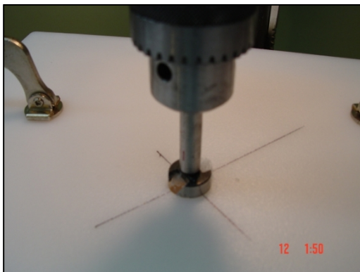
Figures 63, 64 – Perçage du centre de la plaque et mise en place du pivot
