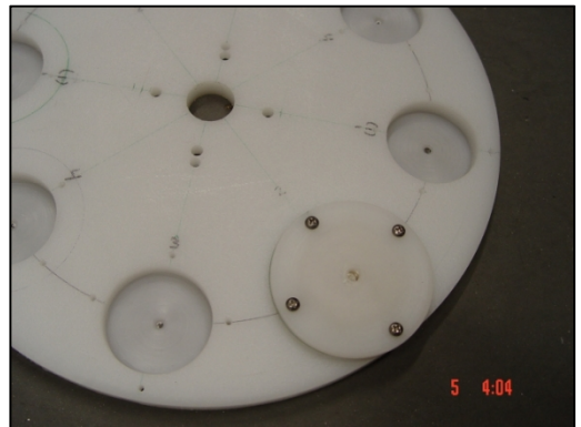
Figures 86, 87 – Mise en place du couvercle au niveau du trou de l'aimant
