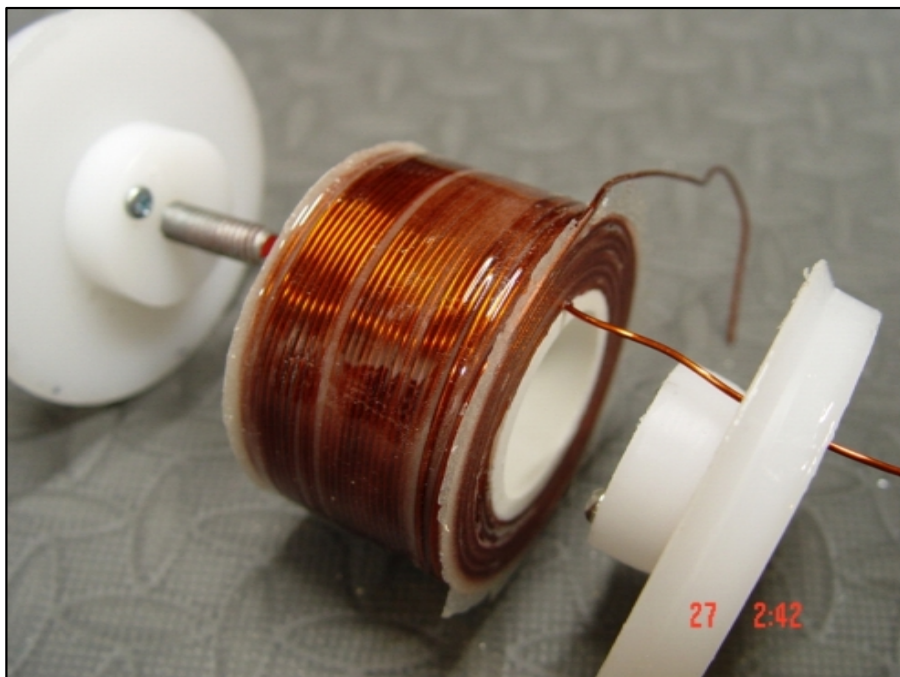
Figure 21 – Une bobine terminée et démoulée
