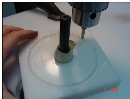
Figures 88, 89 – Création du trou au centre (2,5 cm) et découpe du disque
