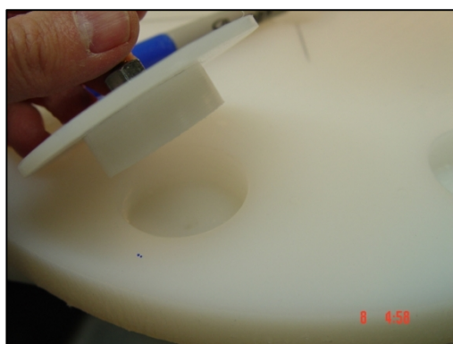
Figures 83, 84 – Mise en place du couvercle au niveau du trou de l'aimant
