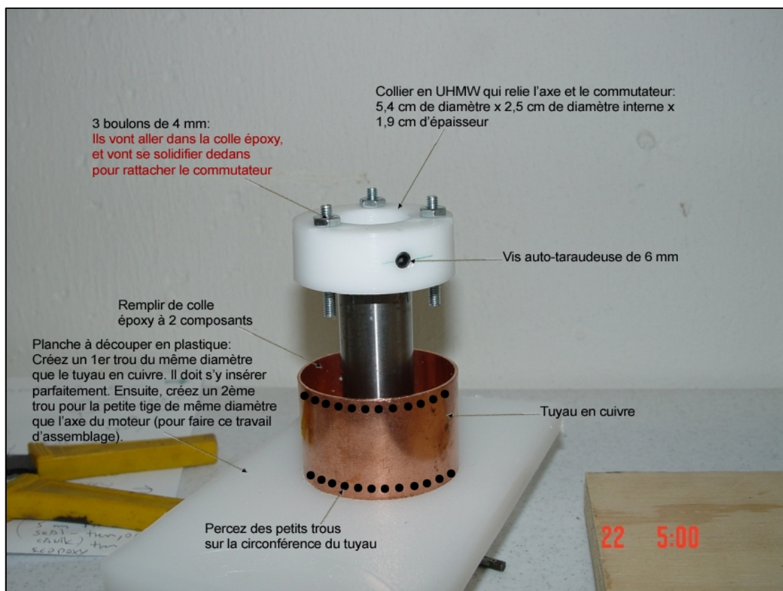
Figure 23 – Assemblage de l'anneau en plastique et du tuyau en cuivre
