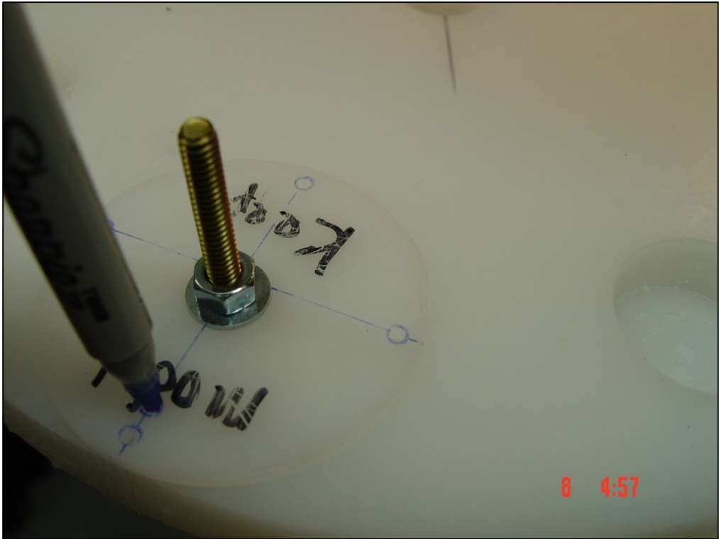
Figure 85 – Marquage de l'emplacement des trous sur l'un des disques du rotor
