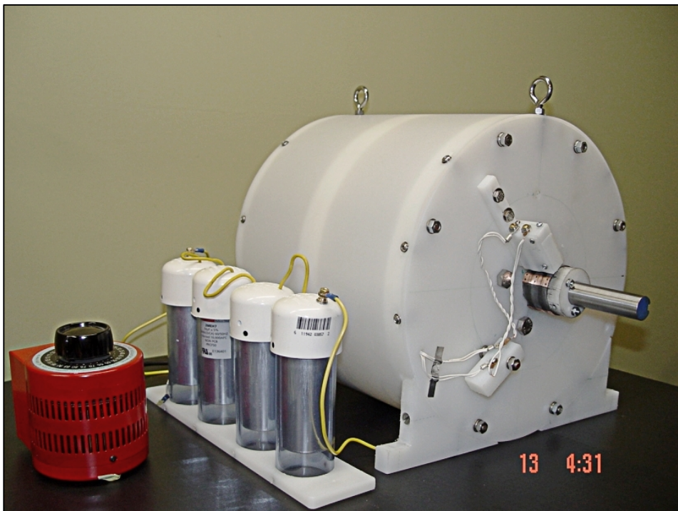
Figure 12 – Photo complète du moteur avec « Variac » (en rouge) pour faire varier la tension d'entrée
