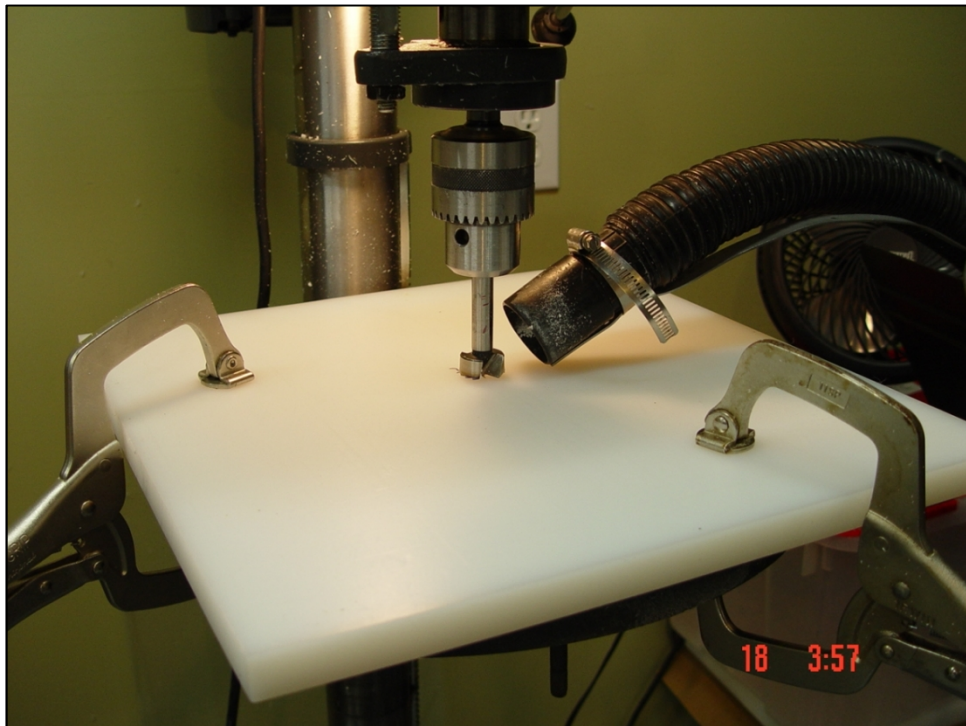
Figure 69 – Utilisation d'un aspirateur pour enlever les résidus de plastique
