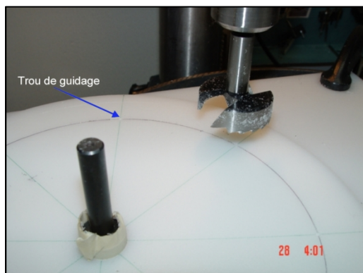
Figures 73, 74 – Perçage des trous pour les aimants
