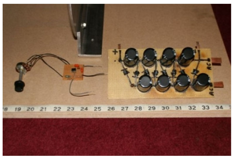
Figure 7 - Vue avant de l'alimentation (avec le traçage au marqueur des connexions)
